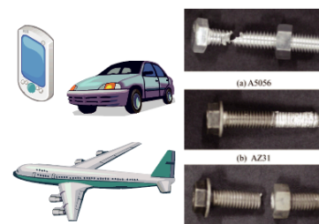
Lightweight technology 非鉄金属ボルトの破断状態
