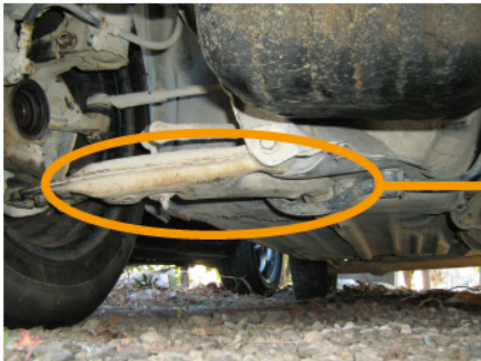
回転自由度を考慮した伝達経路解析の開発と自動車への適用例 (目的: タイヤから車体に伝わる力を知る)
