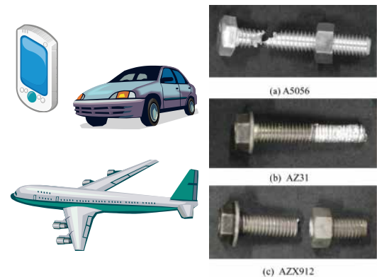
Lightweight technology 非鉄金属ボルトの破断状態
