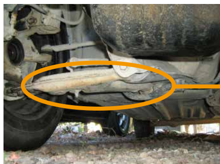
ロアームを取り出して，振動試験
