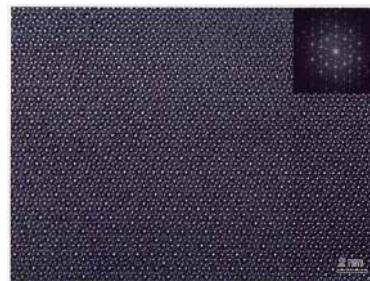
チタン基準結晶の高分解能電子顕微鏡像
