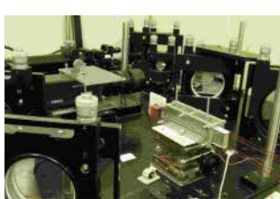
2波長干渉計による多成分ヒートパイプの解析
